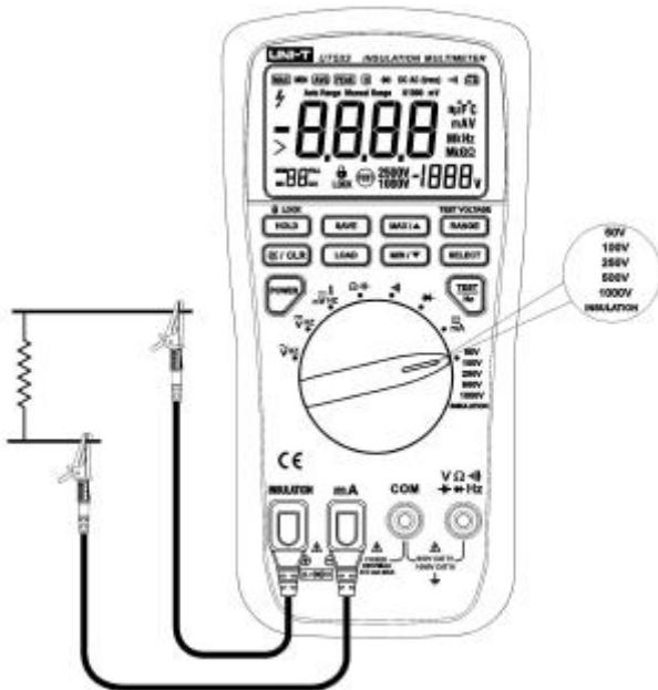
Рис. 15 Измерение изоляции.
