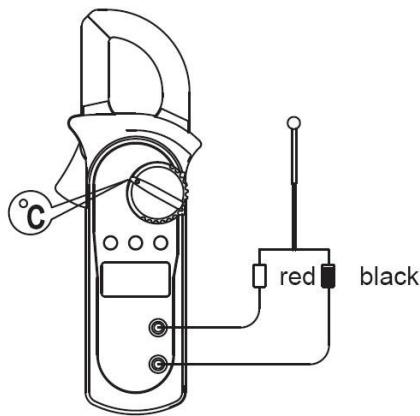
Пределы измерения температуры  $-40^{\circ}\text{C} \sim 1000^{\circ}\text{C}$  и  $-40^{\circ}\text{F} \sim 1832^{\circ}\text{F}$
