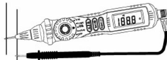
**Замечание.** При разрыве в цепи (т.е. сопротивление ее выше 200 Ом) прибор будет показывать состояние перегрузки "OL".
