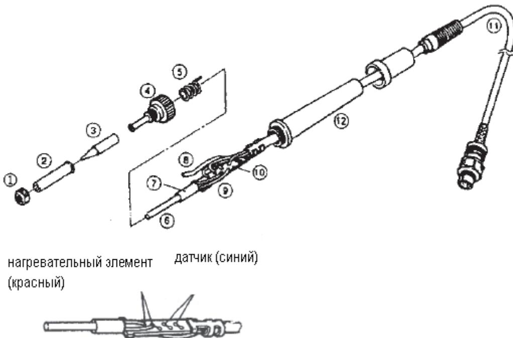
1. Отвернуть против часовой стрелки гайку (1) и снять корпус жала (2) и жало (3).
