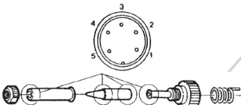
Отключите разъем паяльника и измерьте сопротивление между контактами разъема. Смотрите таблицу, приведенную ниже, если значения строк «а» и «б» выходят за пределы указанных норм, то необходимо заменить нагревательный элемент (сенсор) и \ или шнур (см. проблему № 1 в разделе «Поиск неисправностей»).
