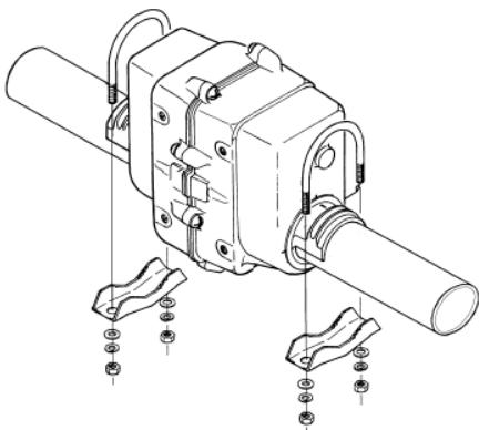
Убедитесь, что оставили достаточный запас управляющего кабеля подъемного устройства и коаксиального кабеля антенного фидера возле азимутного поворотного блока, и что антенна сможет поворачиваться на 450°, не натягивая их. На двойных параллельных системах фидеры следует
