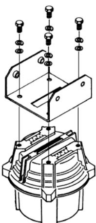
2. Установите блок вертикального перемещения в П-образную скобу, затем закрепите его с помощью четырех болтов M8 X 25, пружинных и плоских шайб.
