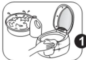
Отключите ванну от сети после использования и слейте жидкость. Не оставляйте жидкость в ванне на длительное время. Вытряхните насухо емкость и корпус.
