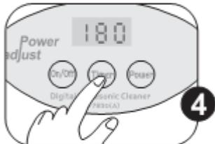
**4. Нажмите кнопку таймера для выбора оптимального цикла работы.** При включении ванны автоматически активируется цикл 180 сек.
