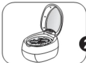
**2. Погрузите предмет в воду, предмет должен быть полностью закрыт водой.** Не превышайте максимальный уровень жидкости, обозначенный на емкости.
