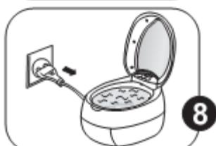
**8. После завершения процесса очистки отключите ванну от сети, откройте крышку и достаньте предмет.** После этого слейте воду и вытрите емкость насухо.
