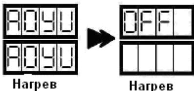
**Примечание:** После подключения шнура питания название паяльной станции может появляться несколько раз, т.е. система пытается определить необходимую рабочую частоту в зависимости от местоположения пользователя. Это не влияет на работу паяльной станции. Если название паяльной станции отображается на экране более трех раз, то смотрите раздел «Выявление основных неисправностей».
